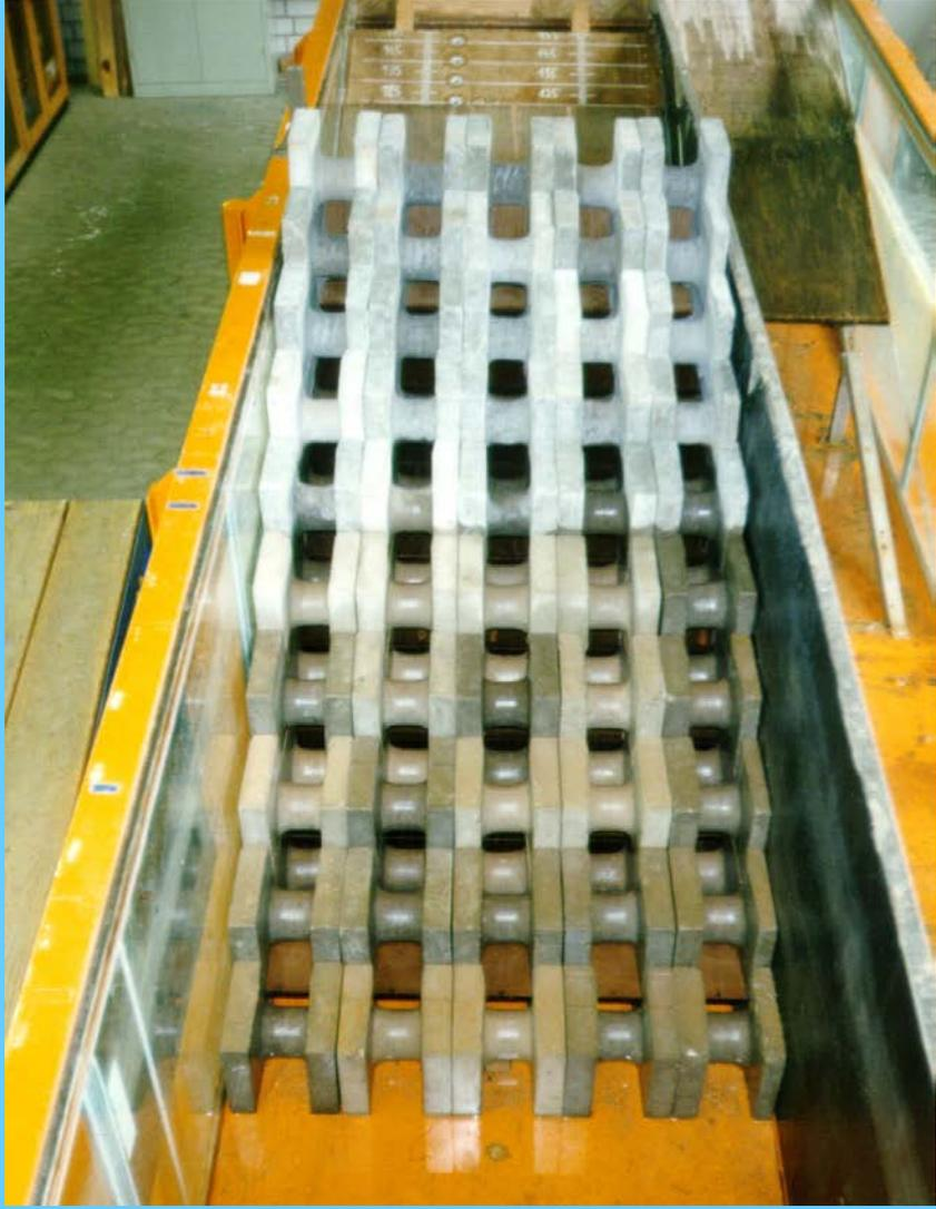
**Hollow Cubes** bilden eine gestufte Böschungsstruktur (2-Lagen-System).
