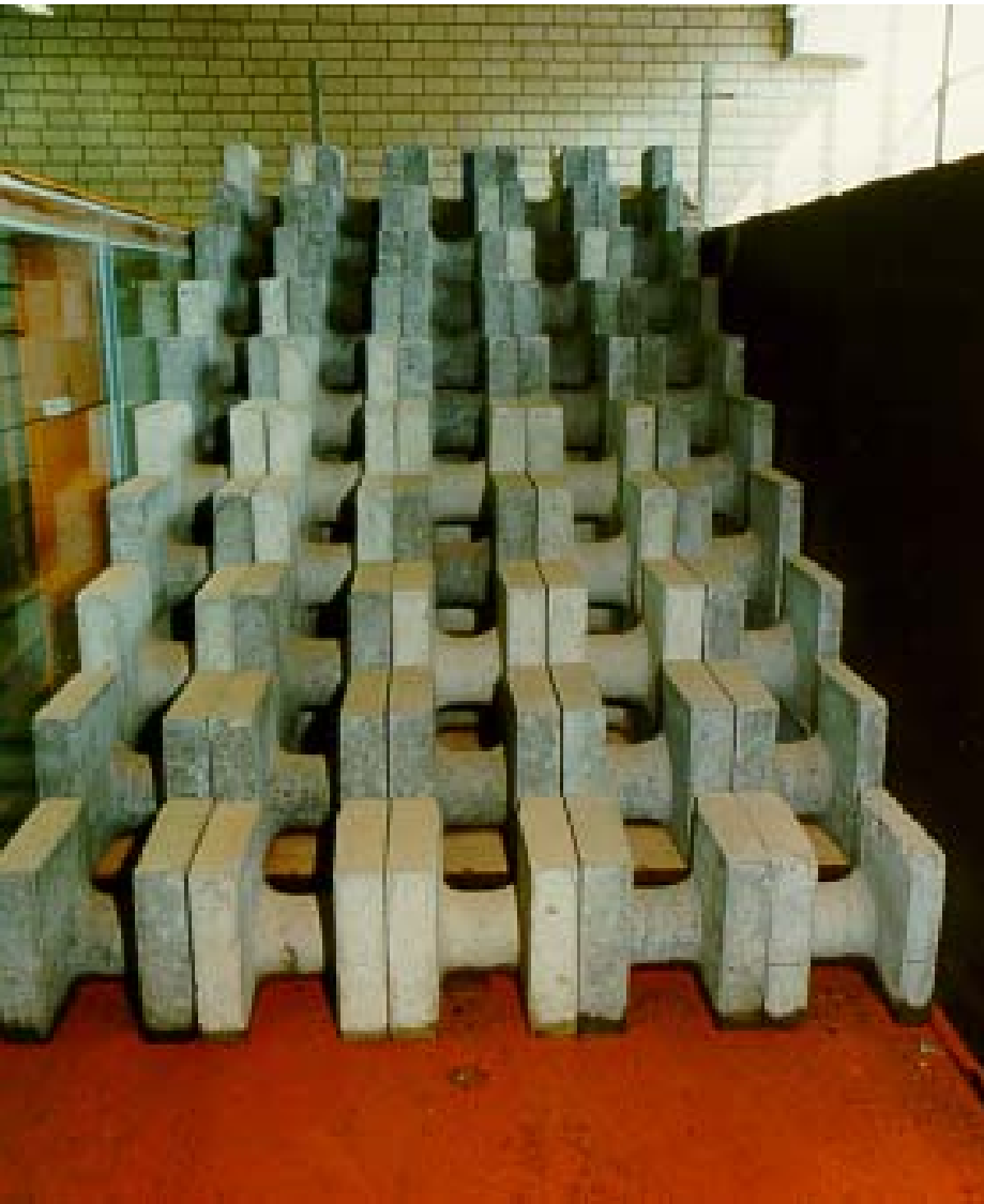
Modellversuche M.1:5 „Hollow Cubes“ (Böschung 1:2 gestapelt).
